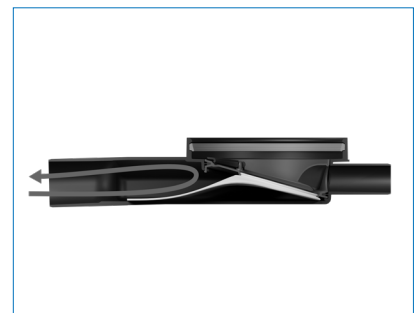
3 Veden tulon loputtua kalvovesilukko sulkeutuu tiiviisti, estäen viemärikaasujen pääsyn huonetilaan.
